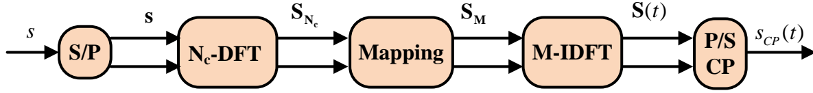
Figure A.3: Esquema de transmisión en SC-FDMA
